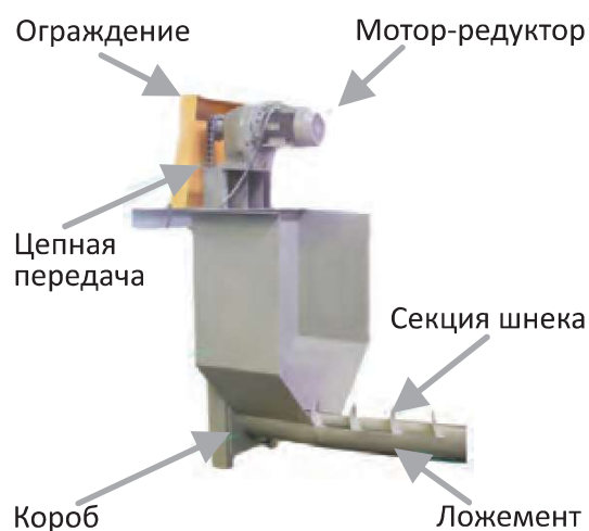
Приводная станция шнекового транспортера ТШГ-190/250
