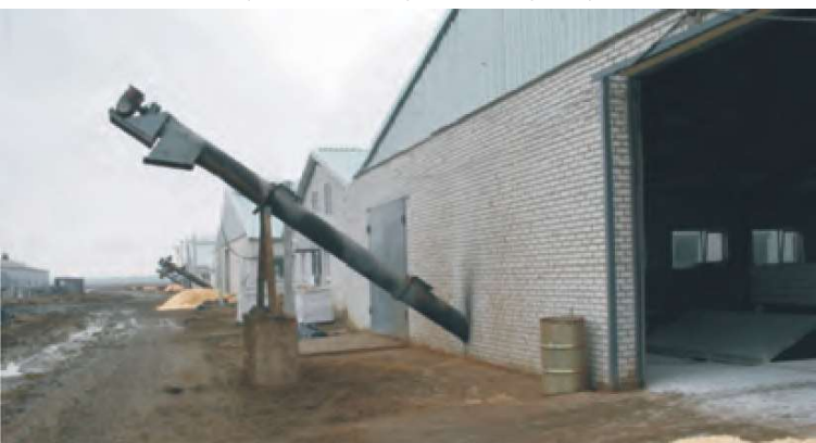
Транспортер шнековый наклонный ТШН-300
